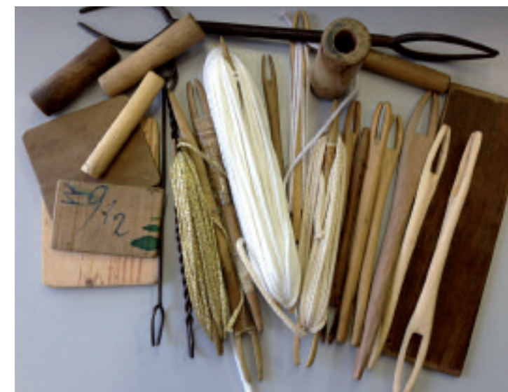
Attrezzi per fare la rete. Tools to build fishing net
